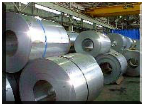
Ilustración 1: Rollos de lámina de acero inoxidable, materia prima para la fabricación de tubería sanitaria.
