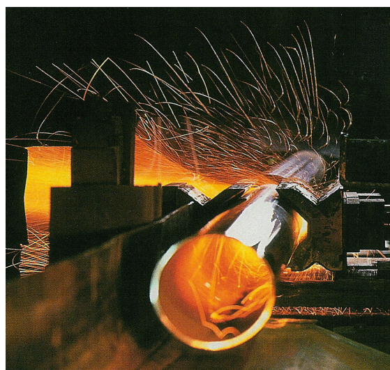
Ilustración 3: Proceso de corte de tramos de tubería sanitaria.
