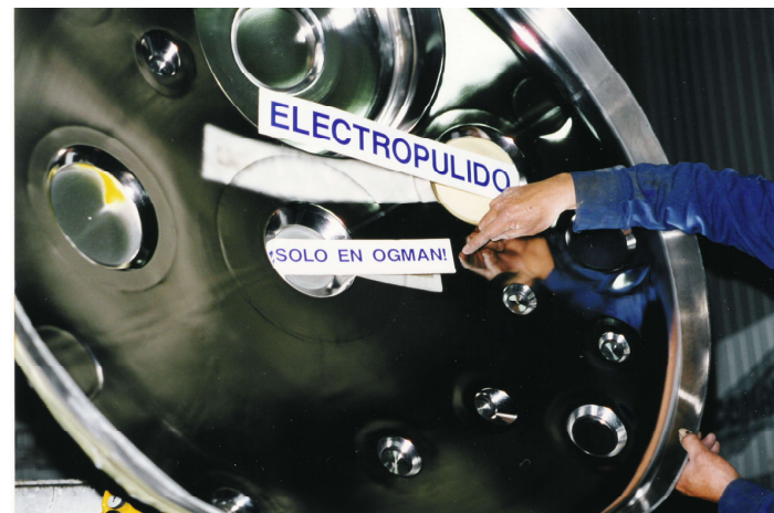
Ilustración 10a: Interior de la tapa de un tanque, en la que se muestra la reflexión del acabado Electropulido.
